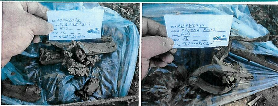
Fig. 17. Investigații geotehnice și prelevare probe de pământ
